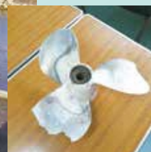
破損したスクルー
