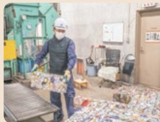
缶は磁力でアルミとスチールに分け、アルミ350缶、スチール450缶ずつ板状に押し固めます。
