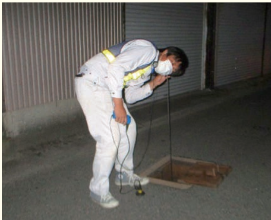
漏水調査の様子（上下水道課、出水主任主事）
