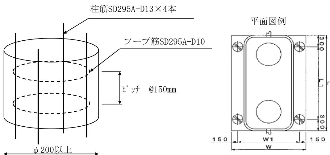
\* 設置される浄化槽の平面積が、従来の浄化槽の平面積より大きい（又は小さい）場合、その面積に応じ、支柱の本数を設定すること。
